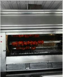
Fotografía No.5 Horno asador que opera con carbón vegetal.
